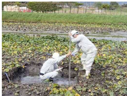
写真 9.1.12 簡易貫入試験状況
