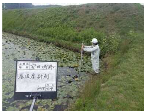
写真 9.1.18 底泥堆積厚調査状況
