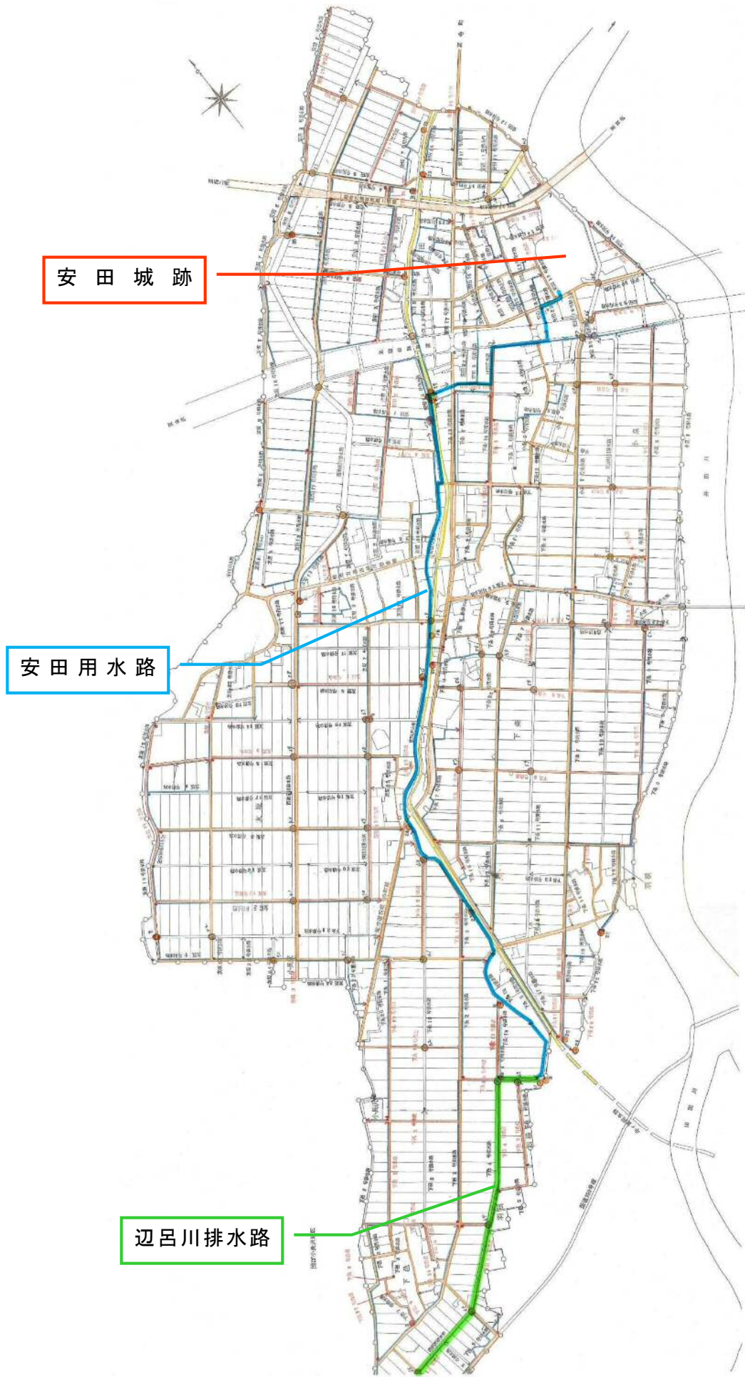
图 4-7 朝日地区用排水路平面图 (朝日土地改良区図面に加筆)
