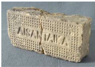
刻印のある耐火レンガ (表面の格子目は、レンガを重ねて積む際、間はさむモルタルがつきやすくするためのもの)
