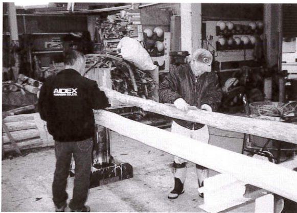
丸太材の節部分等の加工
