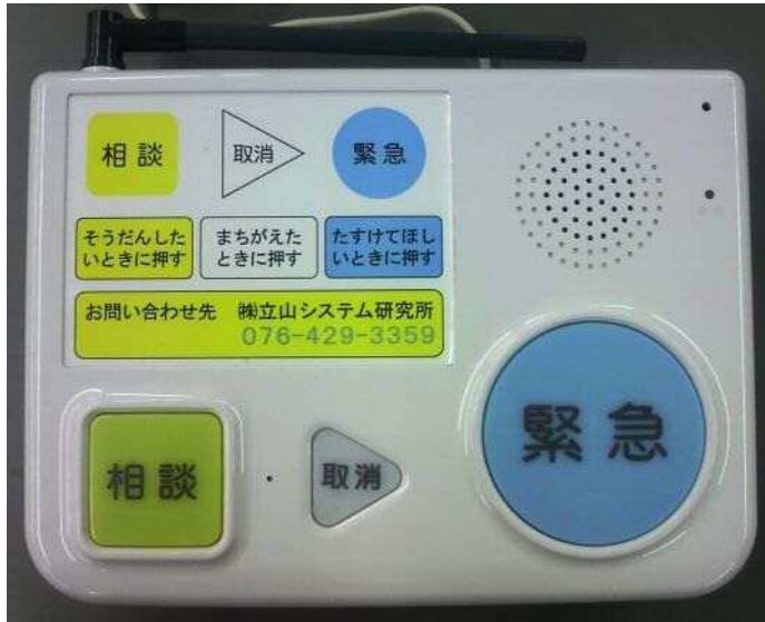
緊急通報装置 (本体)
