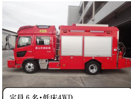
定員6名・低床4WD 長さ7.91m・幅2.30m高さ3.16m
